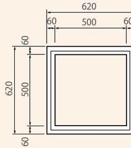
正面図 (側溝ブロック取付部)
