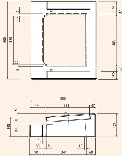
水抜き縁石 質量24kg
