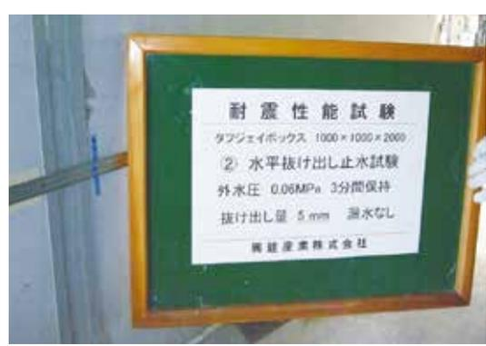
【水平抜け出し+5mm、外水圧0.06MPa負荷、3分間保持、漏水なし】
